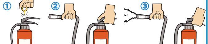
安全ピンを上**に**強く引き抜く。    ホースのノズルを強く引き抜く。    レバーを強く握って噴射する。
