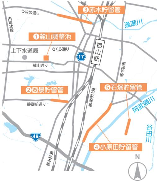
雨水貯留施設は、近年多発する局地的大雨（いわゆる「ゲリラ豪雨」）などによる雨水を一時的に貯留することで、雨水による浸水被害を軽減する施設です。
