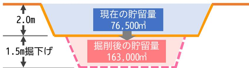
改修により善宝池の貯留量を約2倍に拡大し、周辺地域の浸水被害を軽減
