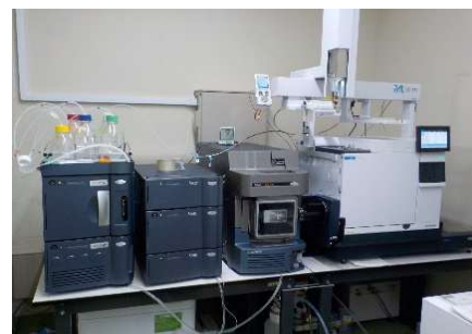
○ 液体クロマトグラフ質量分析計（LC-MS/MS） （分析項目：フェノール・農薬類 等）
