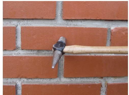
C 2 - 4 ハンマーで軽くたたいて浮きを確認 (音の違いを確認)
