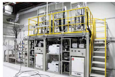
▲電力を水素に変換して貯蔵する実験装置「水素着脱反応触媒評価装置」
