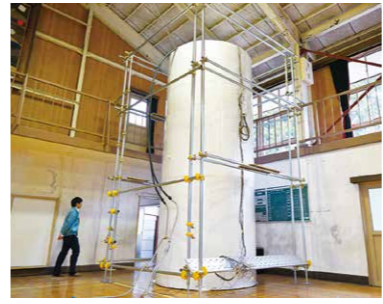
▲模擬採熱チューブの周りを断熱材で覆い、地中の状態を再現
