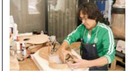
初めに、デザインや材質、パーツなどを決めるが、音色の方向性にも関わる重要な工程でもある。その後、設計図を基に材料の切り出し・加工や塗装、パーツの組み込みを経て、弦を張り音を調整する。佐藤さんは、依頼主の理想形に近付けるため、製作途中で楽器の感触などを確かめてもらうこともある。エレキギターは約4か月、アコースティックギターは約6か月の製作期間を要する。
