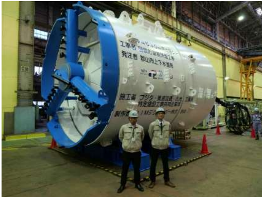
凶景貯留管（直径4,530mmのシールド掘進機）
