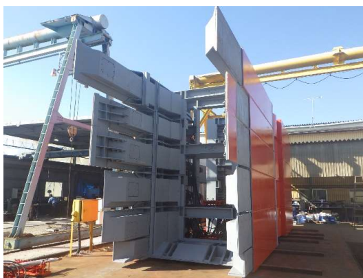
オープンシールド機(R2.2月工場仮組検査時点)
