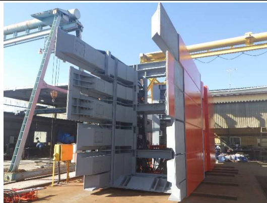
オープンシールド機(R2.2月工場仮組検査時点)
