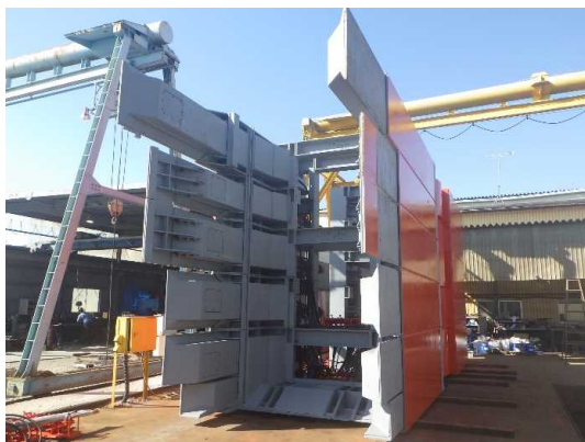
オーブソールト機 ® 仮組立状況(工場内)
