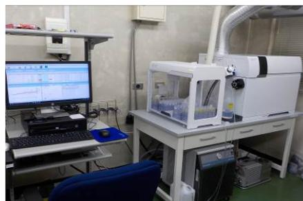
○ 誘導結合型プラズマ質量分析計（ICP-MS）
