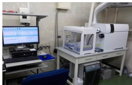
○ 誘導結合型プラズマ質量分析計 (ICP-MS)
