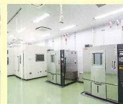
恒温恒湿室、恒温恒湿槽
