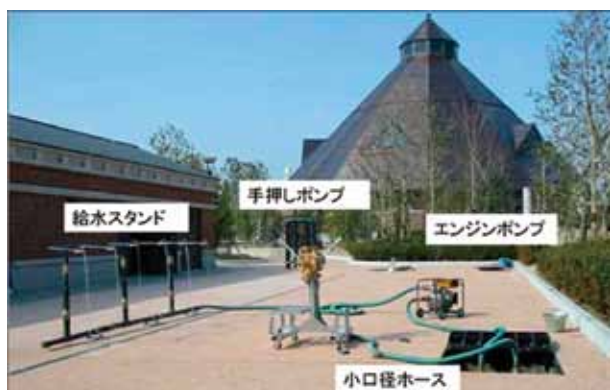
給水時の機材構成
