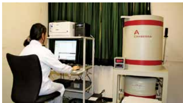
ゲルマニウム半導体検出器による放射性物質のモニタリング検査
