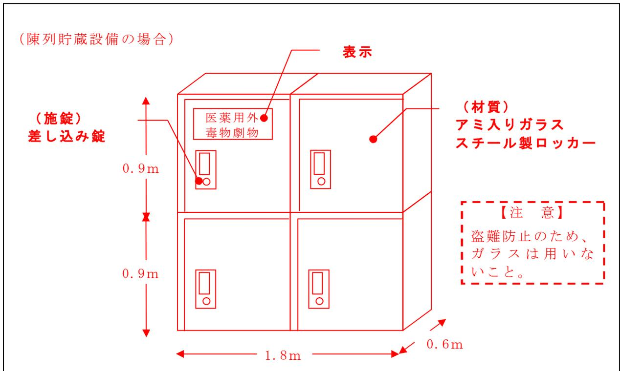
注) 保管棚の材質、施錠状況、表示状況を明示し、寸法(メートル法)を記入すること。
