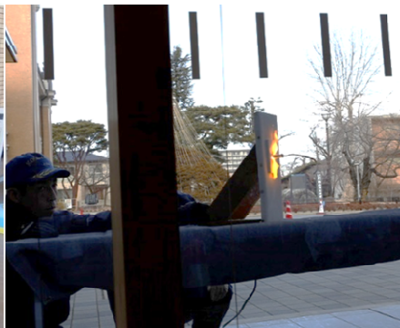
トラッキング火災の再現 「コンセント周りのこまめな清掃を」
