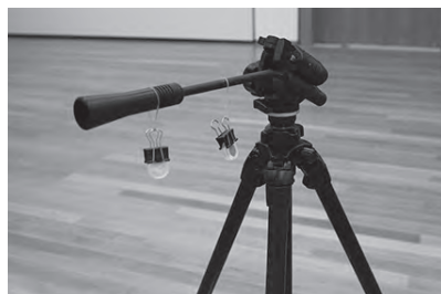
展示室中央で三脚にパッシブインジケータを吊るして測定
