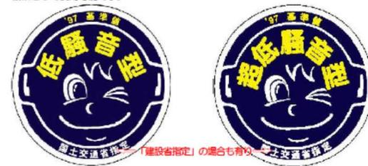
(※4)「97基準値」と記載された右上図のステッカーが添付されたバックホウ、トラクターショベル及びブルドーザーについては環境大臣が指定するものとして規制対象外です。「建設省指定'89」と記載されたステッカーが添付された建設機械については、指定が取り消されており、平成14年10月1日以降は「特定(騒音指定)建設作業実施届出」が必要となっていますのでご注意ください。
