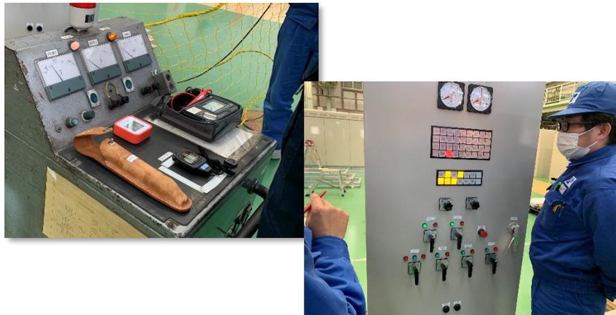
通電試験(耐電圧・絶縁抵抗・故障表示) 検査状況
