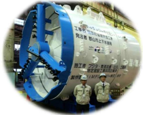
掘進機を地質や深さに合わせて工場製作します。
