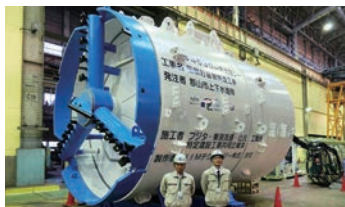
2021年3月完成を目指して工事が進む図景貯留管のシールド掘進機
