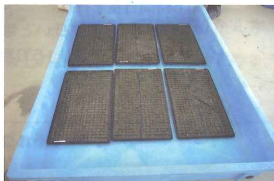
固化処理 底面吸水状況
