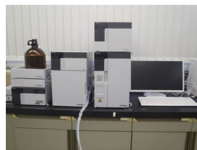
○ 高速液体クロマトグラフ分析計（HPLC） （分析対象項目：陰イオン界面活性剤）
