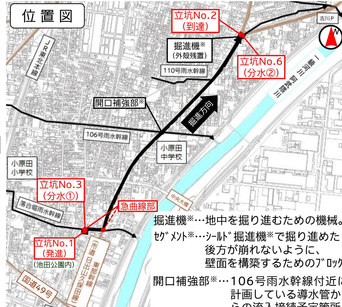
掘進機※…地中を掘り進むための機械。
