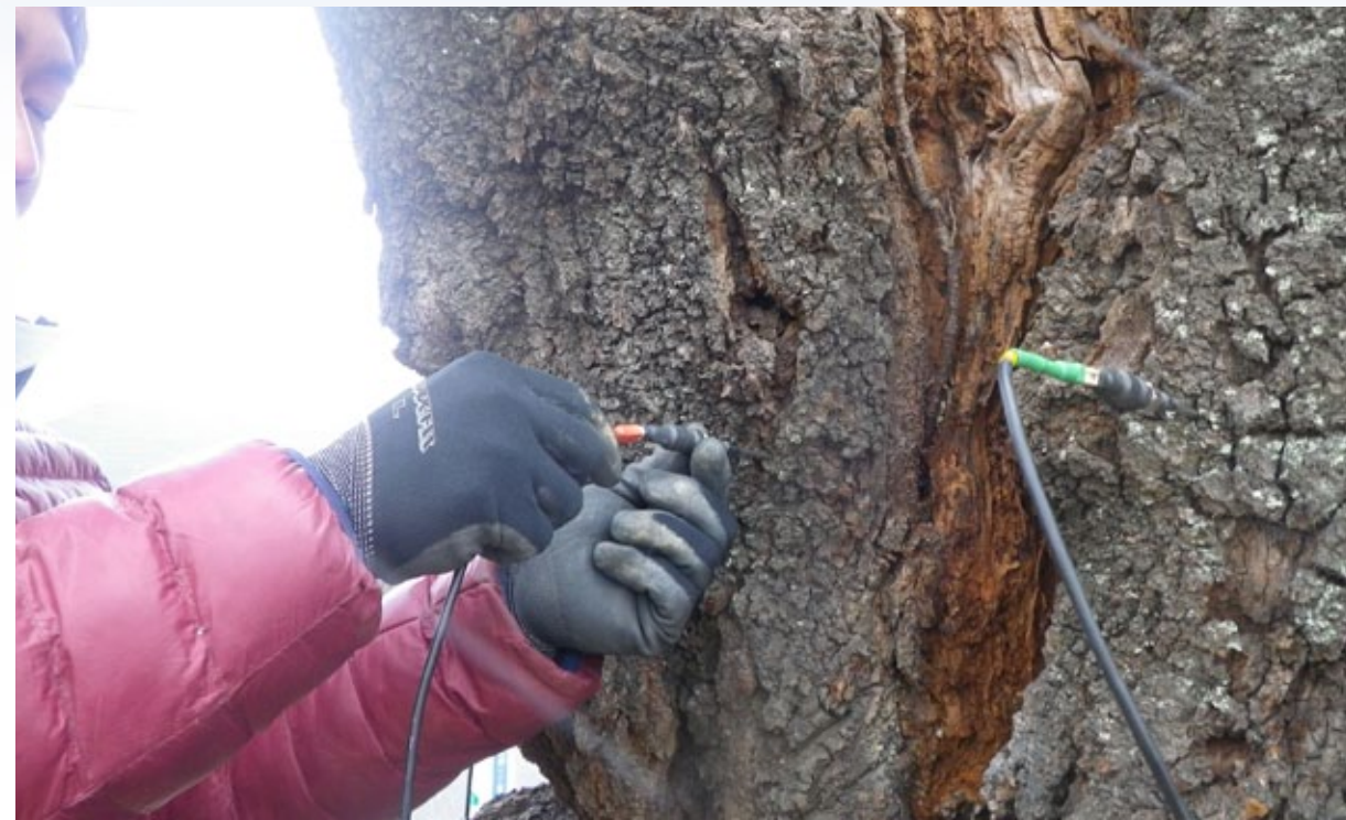
音波測定のための端子の取り付け
