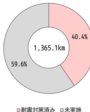
※下水道の耐震化：砕石埋戻による液状化対策や管きよとマンホールの接続部継手の可とう化等の耐震対策をいう。
