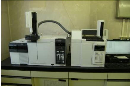
○ ガスクロマトグラフ質量分析計 (GC-MS) (分析対象項目：カビ臭・トリハロメタン等)
