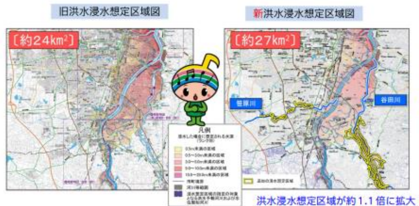
③水位周知河川の追加による洪水浸水想定区域の拡大
