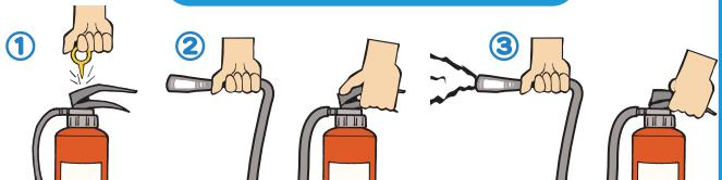
安全ピンを上に 強く引き抜く。 ホースのノズルを持ち、火元に向ける。 レバーを握って噴射する。
