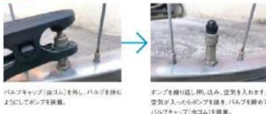
バルブキャップ(空ゴム)を外し、バルブを抜くようにしてポンプを装着。
