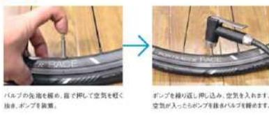
バルブの先端を握り、指で押して空気を軽く抜き、ポンプを装着。
