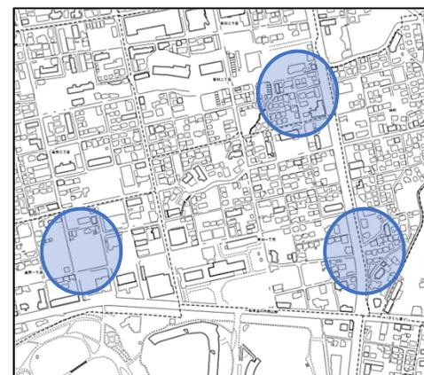
水道水固有の反射特性がある場所を絞り込み、漏水の可能性のあるエリアを半径100mで特定
