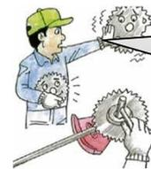
刈り払い機の使用前には刈刃の損傷やネジ類のゆるみを確認してください。
