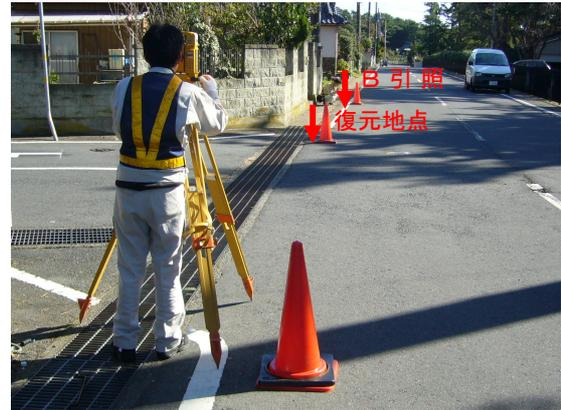
A引照点でのTSによる視準(A引照点～復元地点～B引照点)
