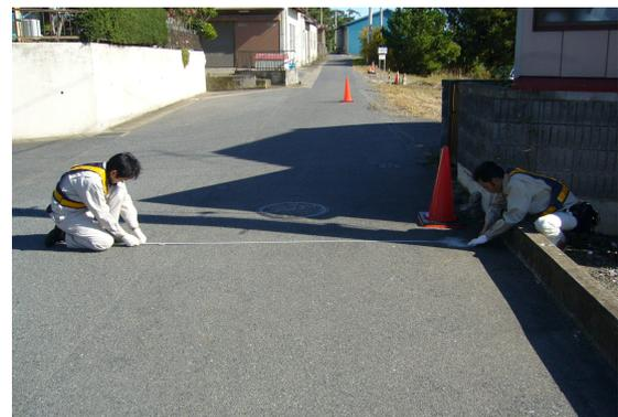
水平距離の測定(D引照点～基準点)
