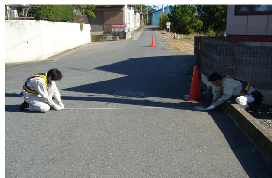
水平距離の測定(D引照点～基準点)
