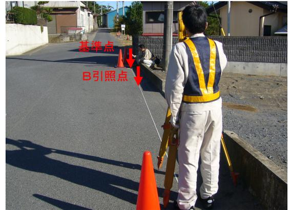
A引照点でのTSによる視準(A引照点～B引照点～基準)
