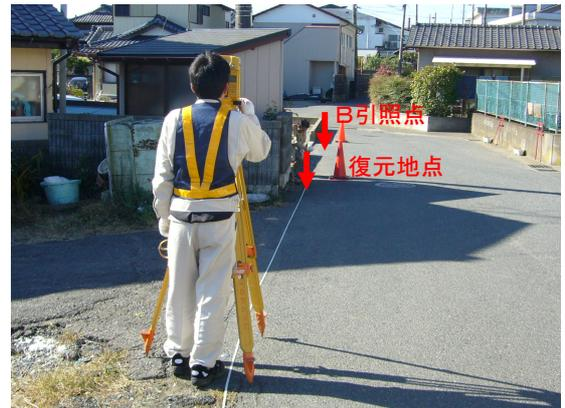
A引照点でのTSによる視準(A引照点～復元地点～B引照点)
