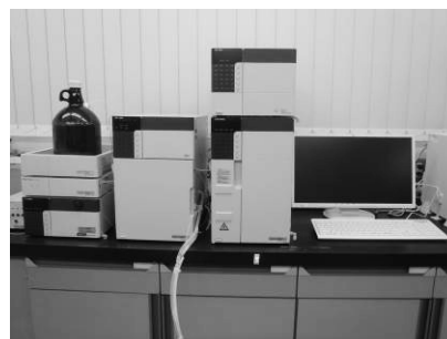
○ 高速液体クロマトグラフ分析計（HPLC） （分析対象項目：陰イオン界面活性剤）
