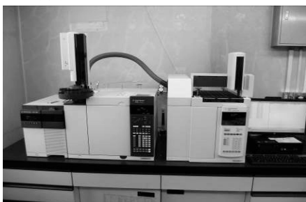
○ ガスクロマトグラフ質量分析計（GC-MS） （分析対象項目：農薬・トリハロメタン等）
