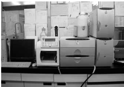
○ イオンクロマトグラフ分析計（IC） （分析対象項目：無機物等）
