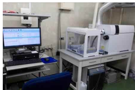
○ 誘導結合型プラズマ質量分析計（ICP-MS） （分析対象項目：金属類）
