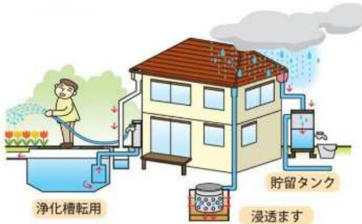
図 43 雨水流出抑制施設\*（雨水活用補助金制度の継続）（ソフト対策\*）
