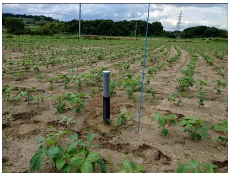
図 2 地下水位計の設置状況
