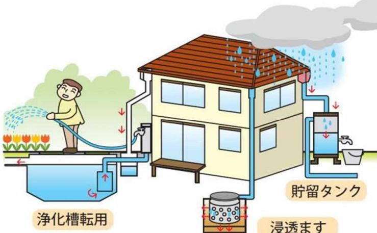
そのほか、利用しなくなった浄化槽を、雨水貯留槽へ転用する補助制度があるよ。
